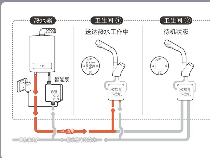
当用户需要使用热水时，不用预先排放热水管里的冷水，打开水龙头秒出热水。
